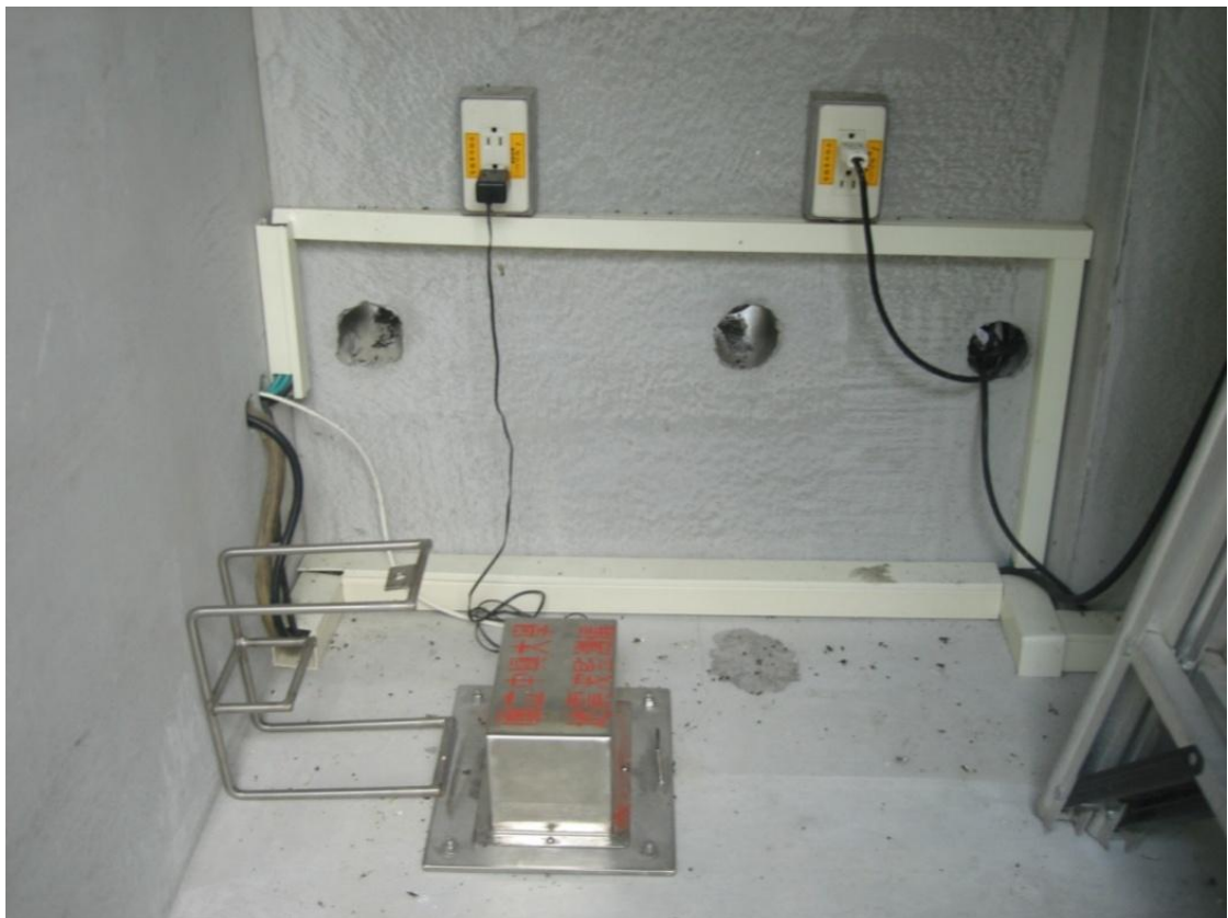
Рисунок 5.24 – Сейсмометр CV-373 (Тайвань-Япония). (Фото Сваловой В.Б.)
