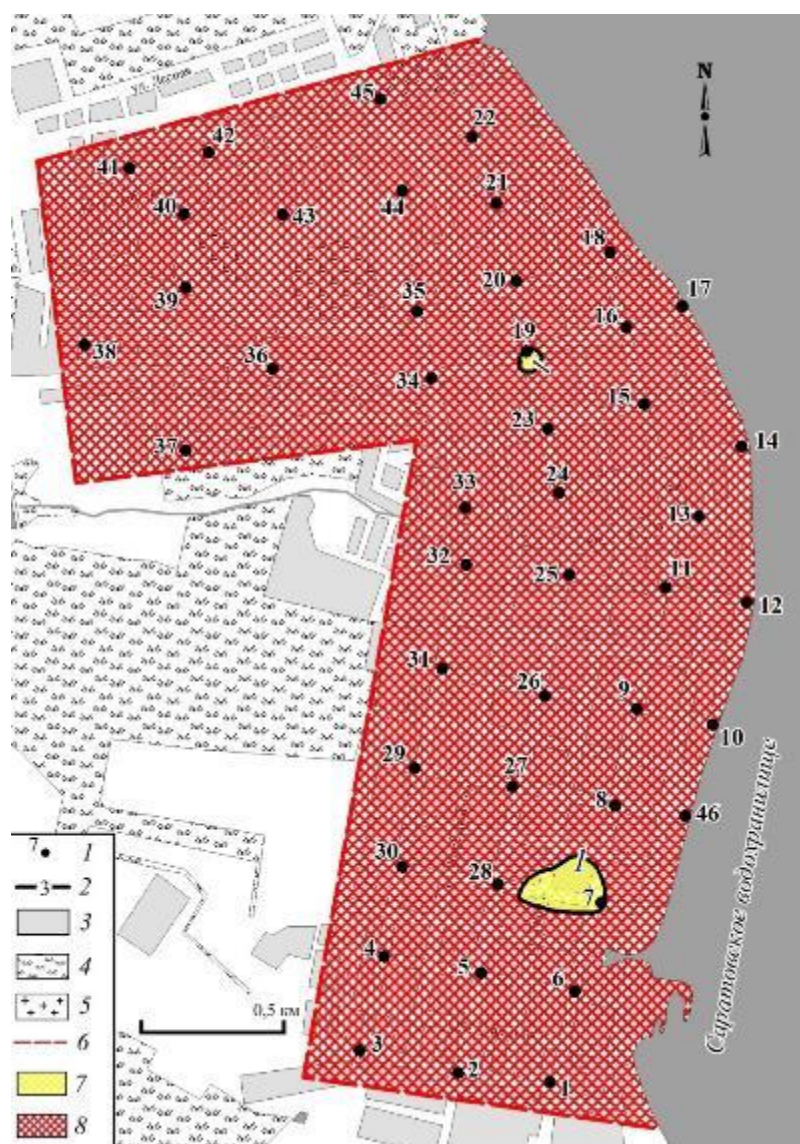
Рисунок 3.37 – Схема распределения индекса загрязнения почвы на территории города Хвалынска (составлено автором): Цифрами обозначены: 1 – площадки опробования, 2 – изолинии величин ИЗП, 3 – застроенные зоны, 4 – зеленые зоны, 5 – кладбище, 6 – граница полигона; категория загрязнения участка по ИЗП: 7 – проблемная (0,75–1 ед.), 8 – загрязненная (>1 ед.)
